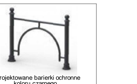
Projektowane barierki ochronne koloru czarnego (rozstaw co 1,4 m)
