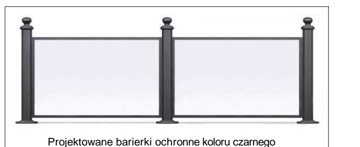
Projektowane barierki ochronne koloru czarnego z ekranem z poliwęglanu grubości 4 mm
