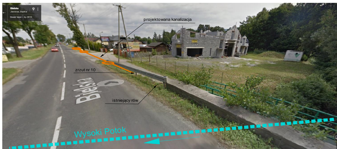
Widok miejsca wylotu kanalizacji deszczowej do rowu przydrożnego – zrzut nr 9 i 10
