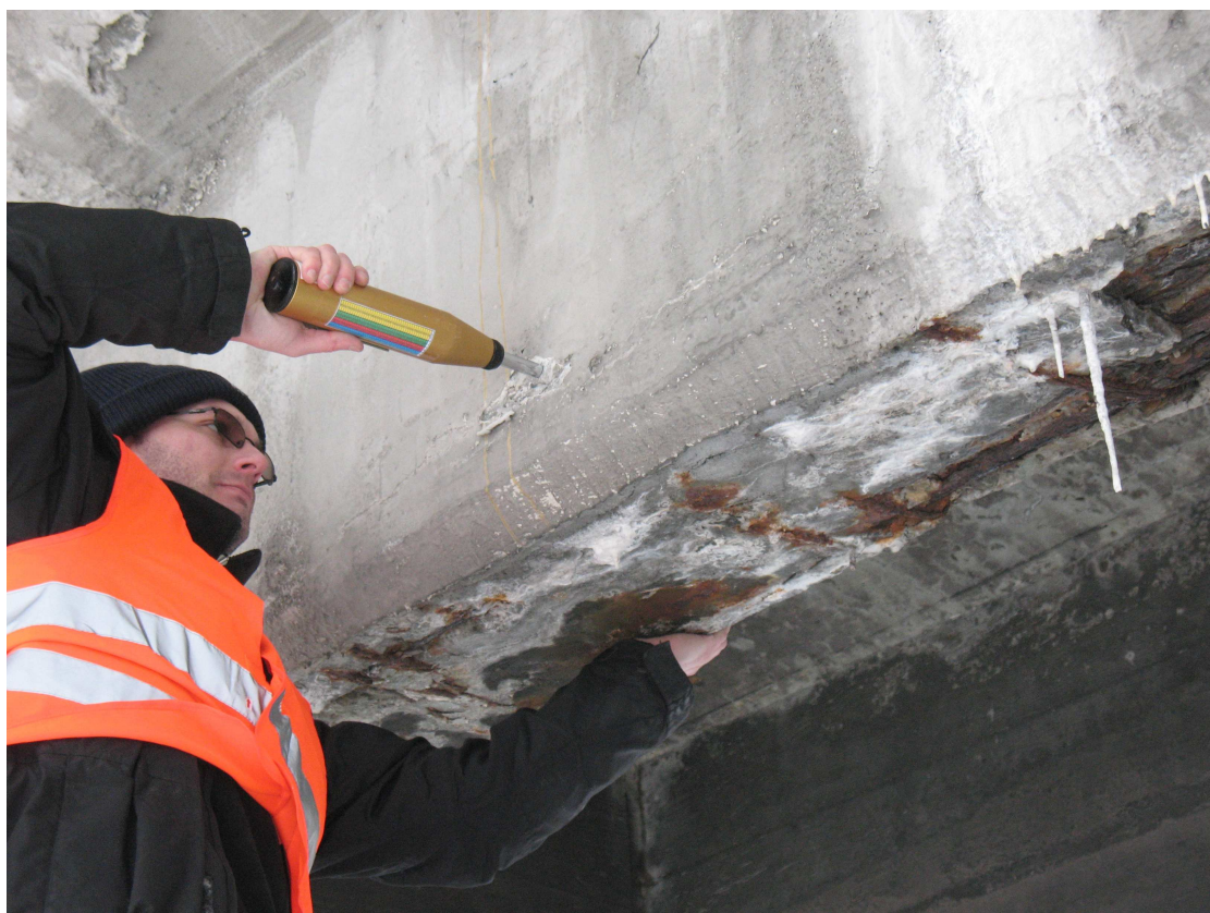
Fot. 1 Badanie wytrzymałościowe dźwigara skrajnego.
