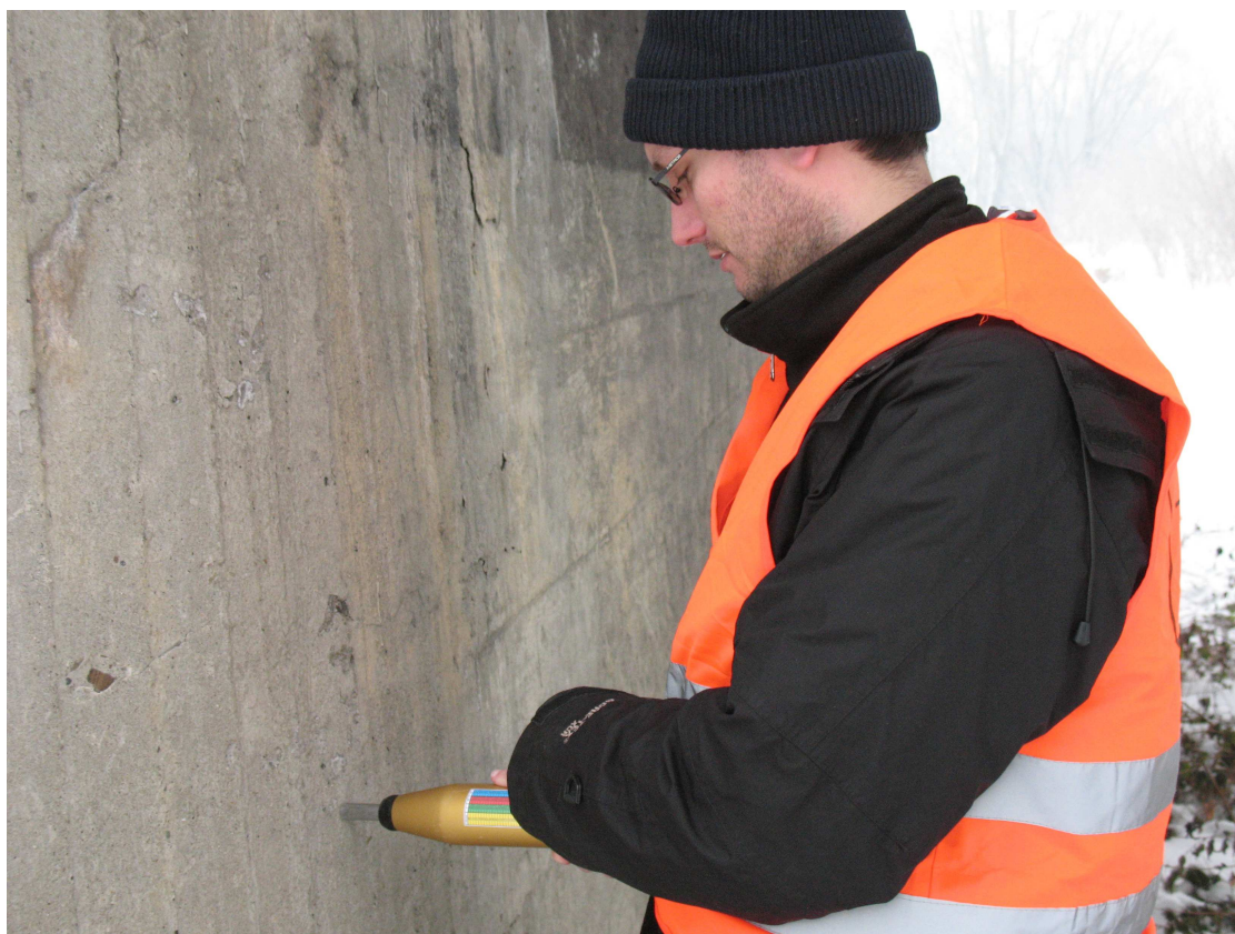
Fot. 2 Badanie wytrzymałościowe filara.
